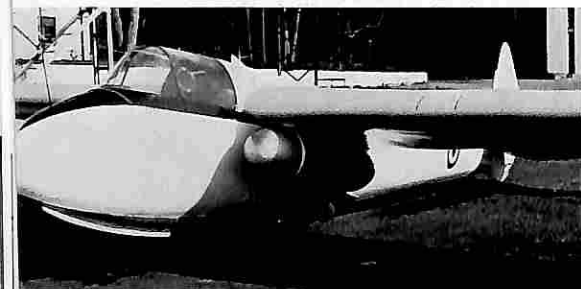
Il «Canguro» a getto dotato di serbatoio supplementare.
