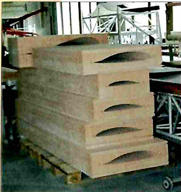
L'assemblaggio delle varie parti degli stampi, e i tralicci di sostegno
