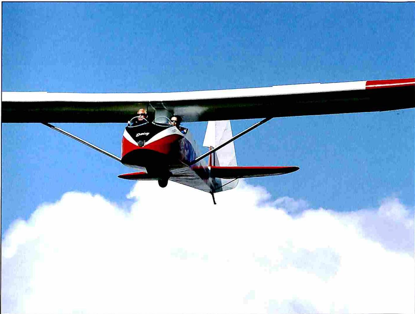
*Lo Slingsby T 21 del 1944 deriva dal Grunau Baby con le modifiche necessarie per il secondo posto. Nacque così il primo biposto-scuola inglese e si poté abbandonare l'istruzione su monoposto. 16,5 m d'apertura, e 24 d'efficienza*
