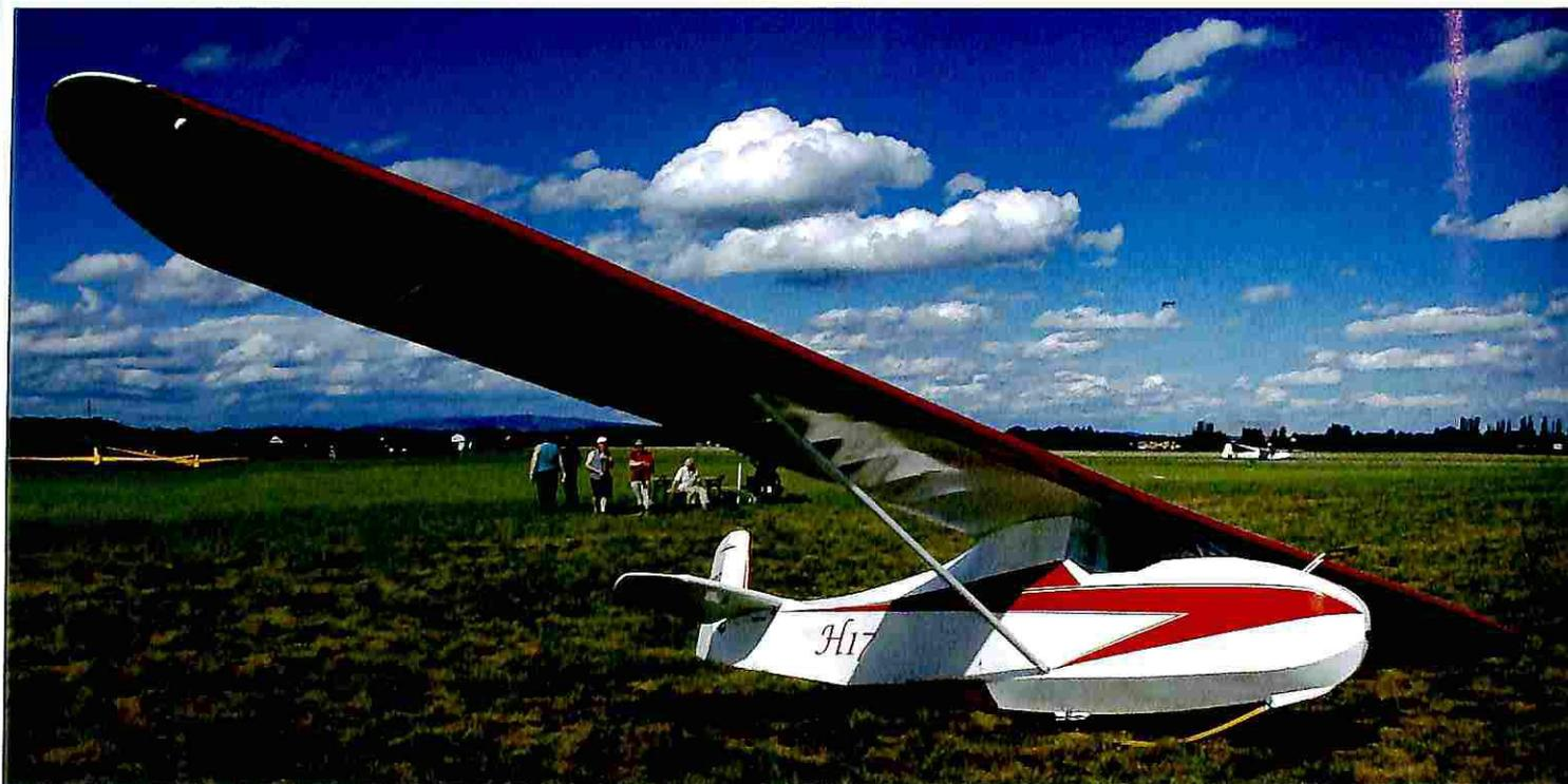
**L'Hutter 17 era un progetto dei fratelli Hutter, che ne distribuivano i piani di costruzione. In seguito essi entrarono in Schempp-Hirth. Circa 100 gli esemplari costruiti. Efficienza max 17:1 a 64 km/h, per soli 9,7 m d'apertura e 65 kg di massa a vuoto (93 kg il carico massimo in cabina)**
