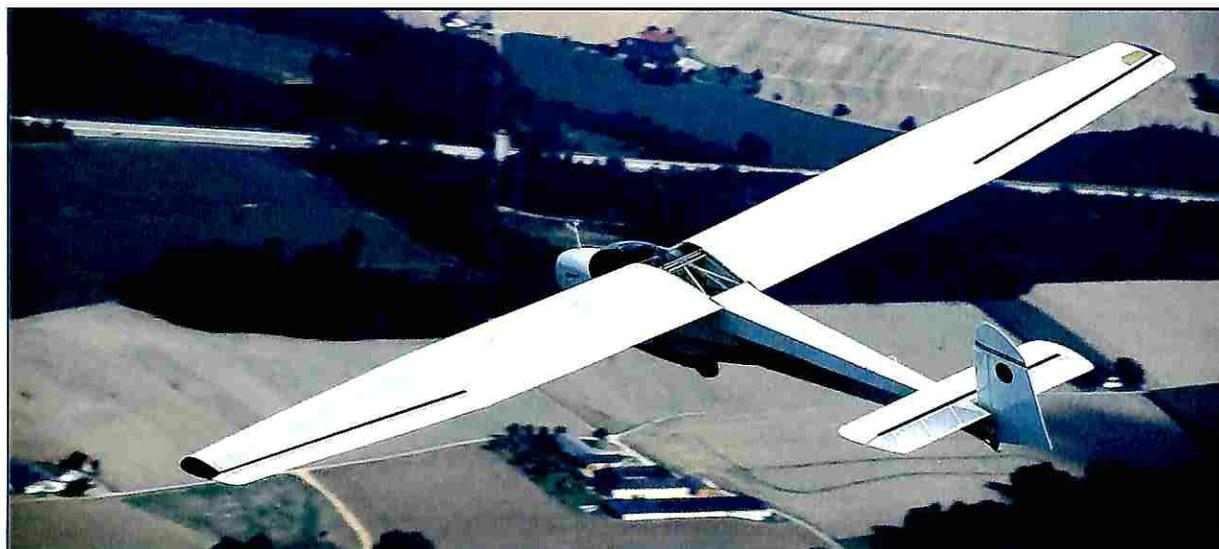
**L'Hutter 28 è il primo aliante dotato di capottina preformata in un unico pezzo. Con 12 metri d'apertura, l'efficienza misurata è pari a 24, contro i 28 di progetto**
