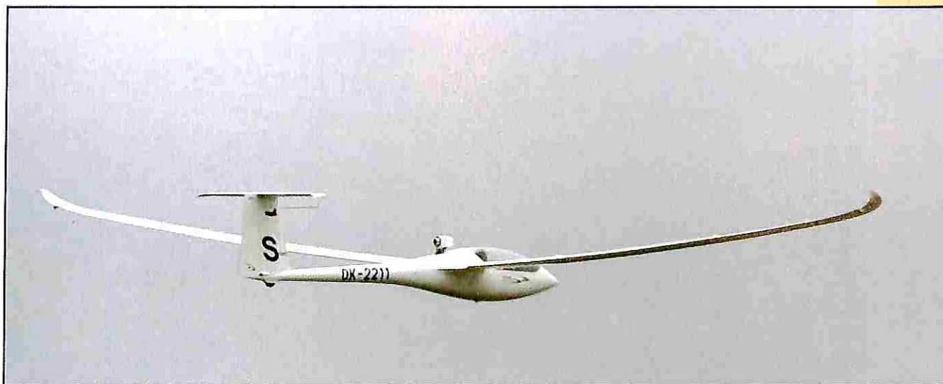
In volo a motore. La modesta massa dei gas di scarico non porta ad aumenti di temperatura della deriva, che comunque è stata protetta con un nastro metallizzato
