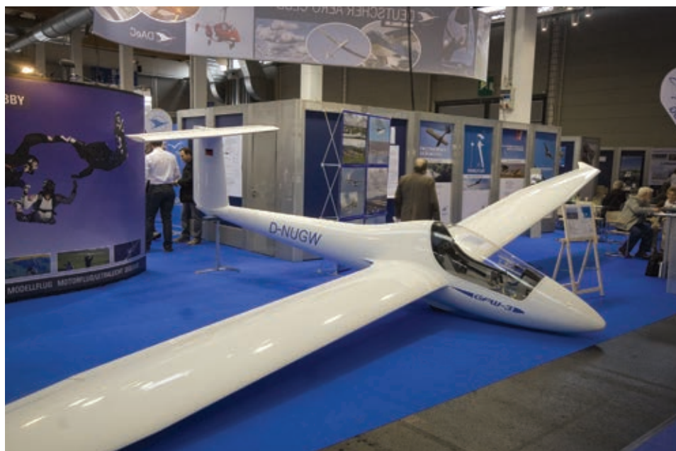
Il monoposto da 80 kg GFW-3 (in realtà 120 kg con balistico, secondo la norma tedesca). Il progettista cerca soci per l'industrializzazione
