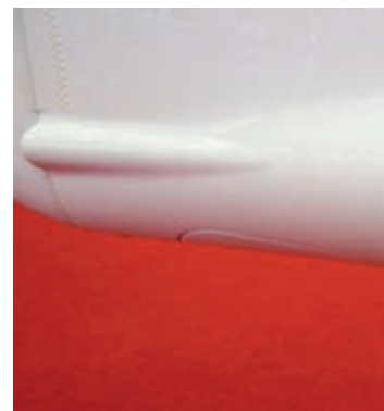
Il ruotino di coda dell'ASG-32, retrattile e sterzabile, un optional di forte richiamo
