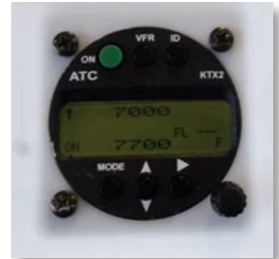
Un nuovo transponder modo-S con capacità di trasmissione ADS-b, dalla Dittel Avionic
