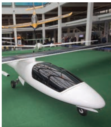
Il SunSeeker Duo, basato su parti dello Stemme, per un biposto leggerissimo in grado di volare con l'energia solare. Realizzato da Eric Raymond
