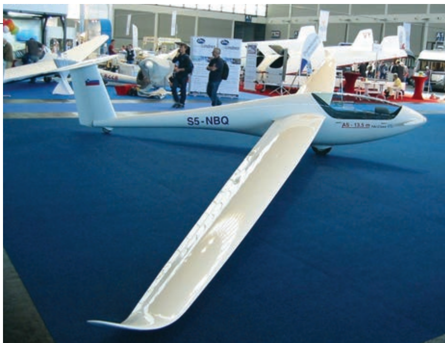
Il FES, motore installato nel cono di prua, si sta diffondendo su molti modelli. Qui l'Albastar 13.5m, monoposto ultraleggero
