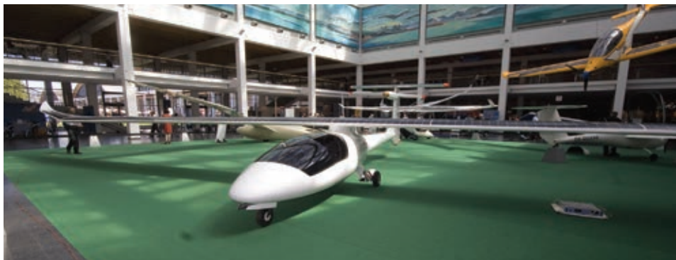
Il SunSeeker Duo, basato su parti dello Stemme, per un biposto leggerissimo in grado di volare con l'energia solare. Realizzato da Eric Raymond
