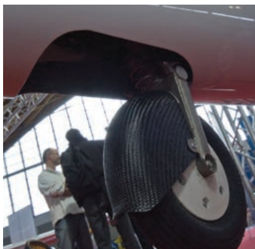
Il ruotino di coda dell'ASG-32, retrattile e sterzabile, un optional di forte richiamo
