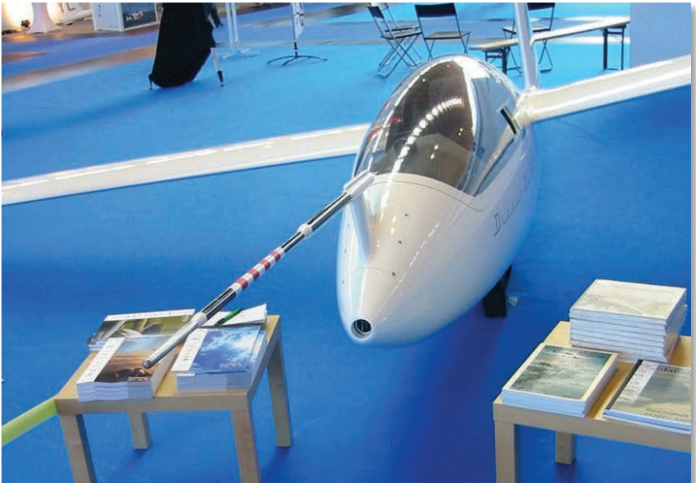
Nello stand Idaflieg, l'associazione dei gruppi universitari, era presente il Discus 2c "DLR" con sonde speciali e che è stato promosso al ruolo di "vacca sacra" quale aliante di confronto per le prove di volo e di rilevamento della polare (sostituisce il vecchio prototipo di DG-300 17 metri)
