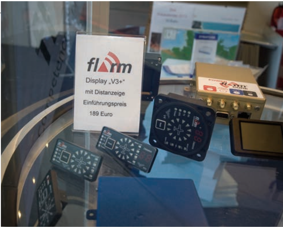
Flarm display in tre versioni, ora anche con indicazione digitale a due cifre della distanza dell'oggetto
