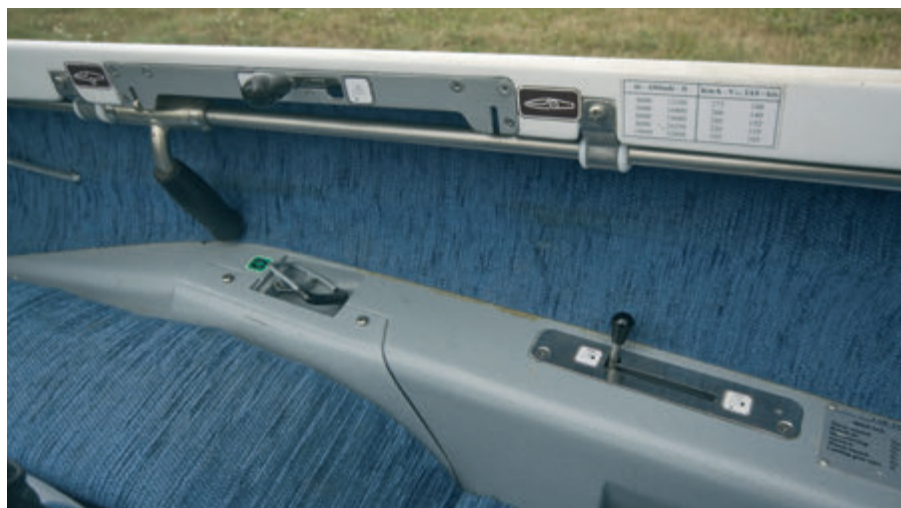
Lato destro dell'abitacolo: comandi per i ballast principali, ballast di coda, carrello e regolazione pedaliera
