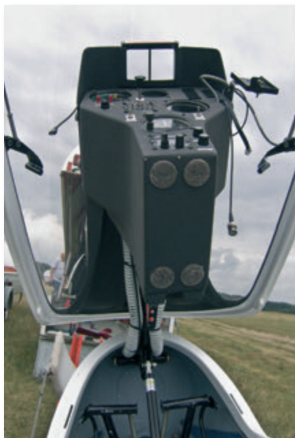
Il pannello strumenti integrato alla capottina
