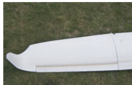
Visto da sopra, il terminale appare troncato
