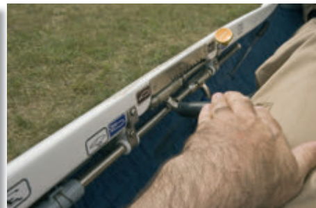
Lato destro dell'abitacolo: comandi per i ballast principali, ballast di coda, carrello e regolazione pedaliera
