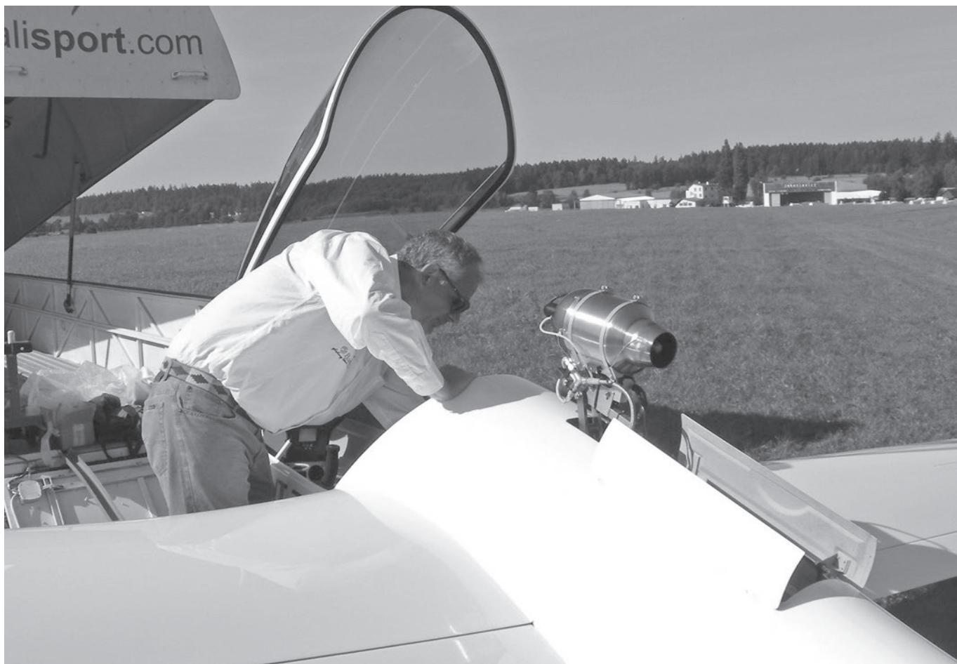
Stefano Ghiorzo esegue un test al suolo del motore a getto installato sul suo Silent 2 Targa Jet
