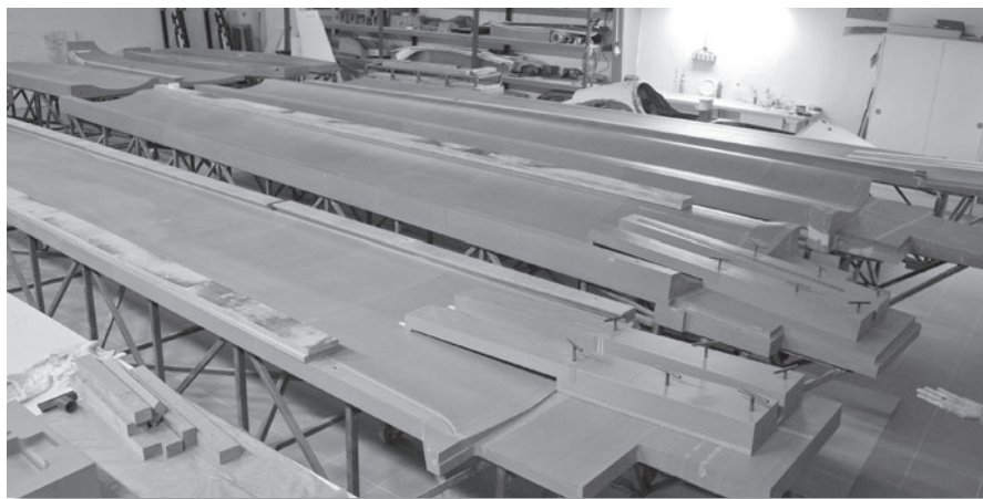
Gli stampi lavorati dal pieno con le macchine di precisione della HpH. Il materiale sintetico, di colore marrone chiaro, garantisce buona durata ed eccezionale facilità di lavorazione
