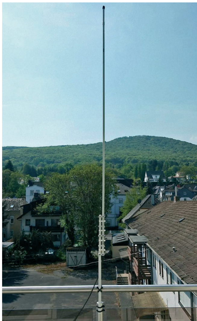
Un'ottima antenna del tipo "collineare", ben installata su un tetto
