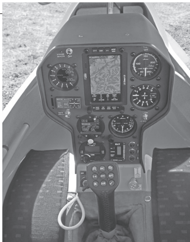
Pannello strumenti di un Silent, con computer Zeus, vario LX, Flarm e strumento di controllo del motore elettrico FES
