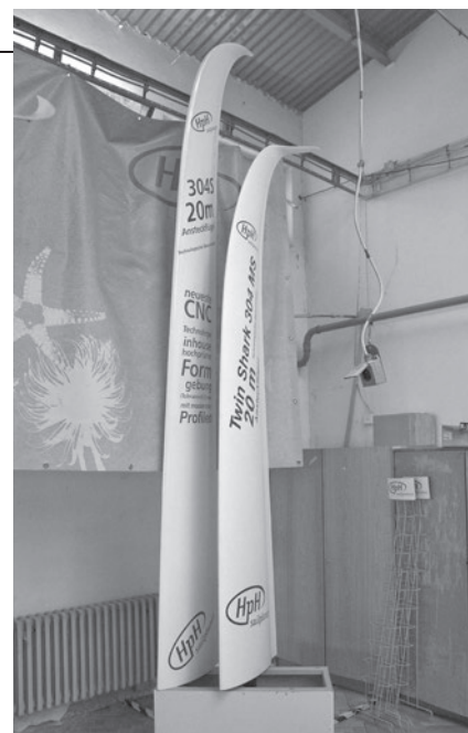
La semiala per il monoposto 20 metri, accanto al terminale dell'ala prevista per il biposto Twin Shark, che avrà i flap
