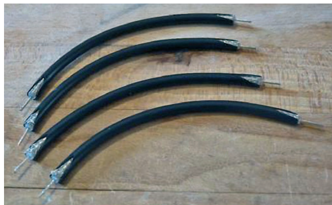
Quattro dei dodici spezzoni di cavo che formano l'antenna collineare
