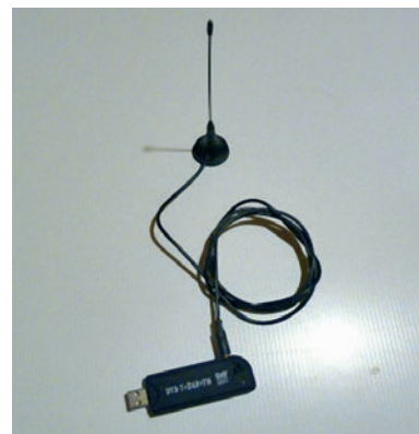
Un classico ricevitore TV digitale terrestre da collegare a un computer via USB
