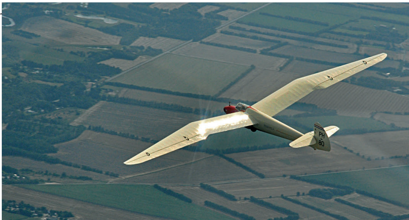
Il Minimoa, monoposto da 17 metri. Fu il primo a portare zavorra d'acqua, in fusoliera
