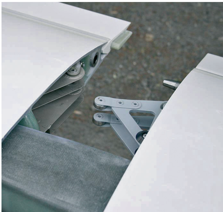
Connessioni automatiche anche sulle estensioni alari
