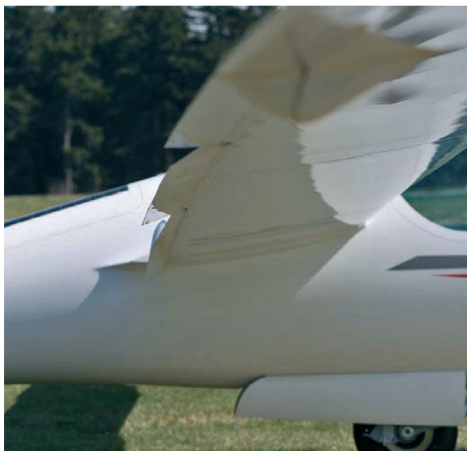
L'estensione dei flap in posizione Landing
