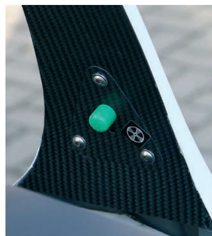
Pulsante che controlla la ventilazione centrale
