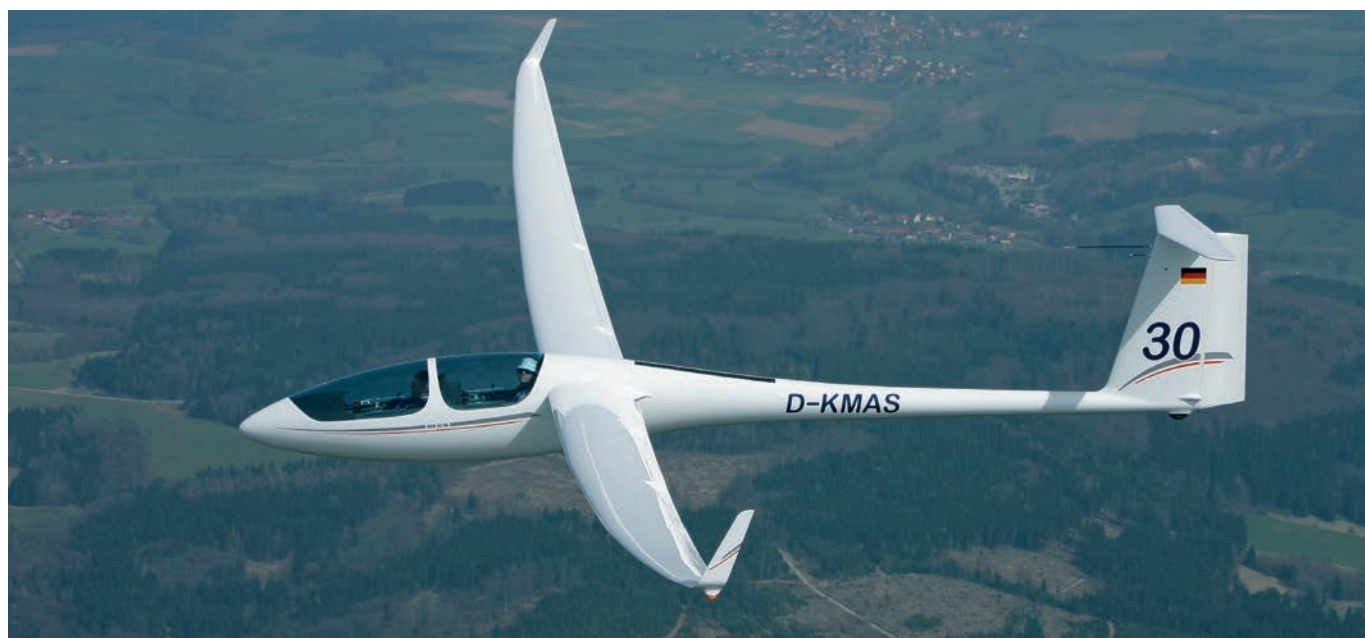
La fusoliera è lunga, con alta deriva e un cockpit che spicca, soprattutto per il confronto con l'allungamento delle ali
