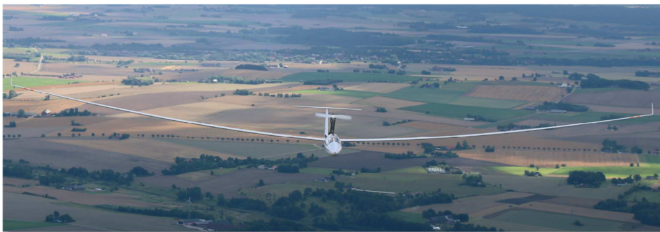
Impressionante l'estensione dell'apertura alare. In opzione è consigliato aggiornare i terminali alari con la variante "Edition" per le alte velocità
