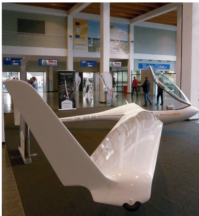
Il terminale alare del Pulse, e l'andamento del bordo d'attacco
