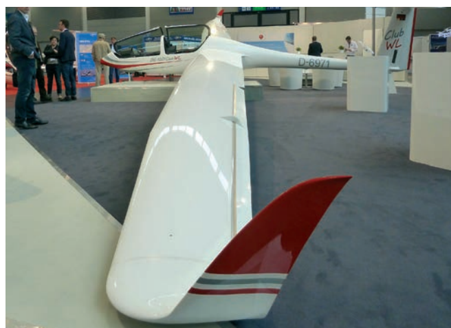
Il DG-1001 club ora dotato di winglet anche per l'apertura di soli 18 metri
