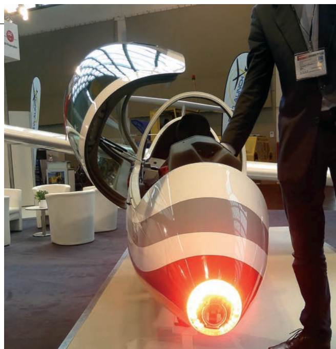
Luce stroboscopica a Led frontale, collegata anche alla ricezione Flarm
