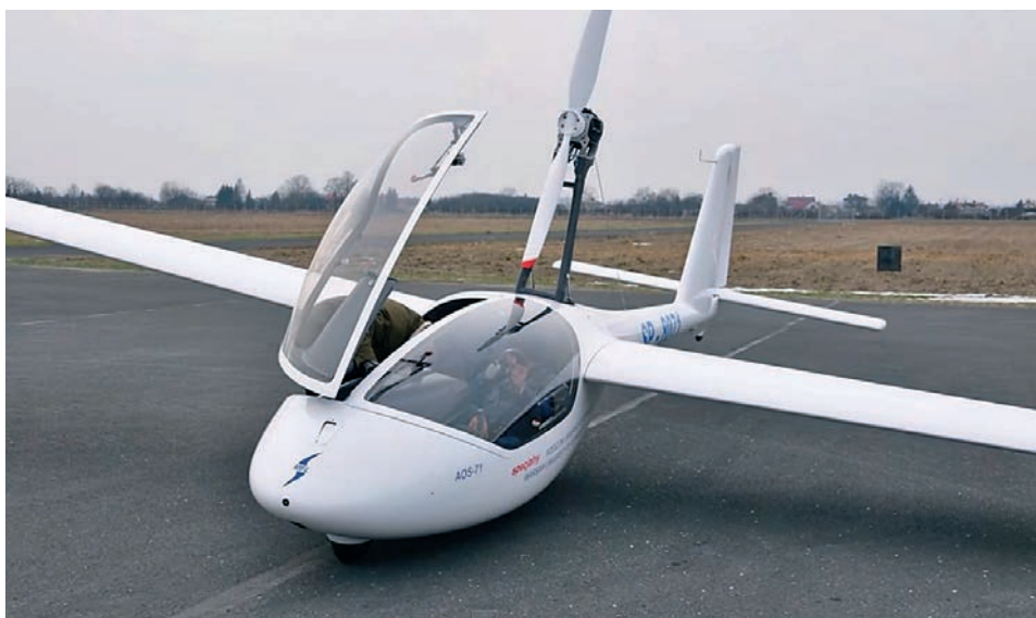
AOS-71, un progetto realizzato da studenti di due università polacche: ali del PW-6 e una nuova motorizzazione elettrica
