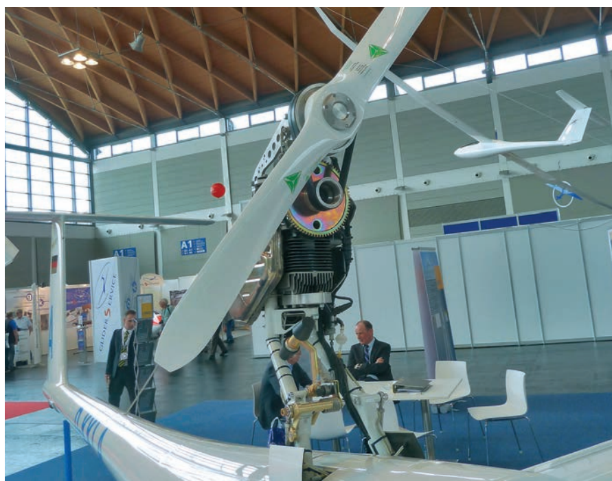
Dettaglio del motore T dell'Antares. In via sperimentale ha permesso anche il decollo autonomo
