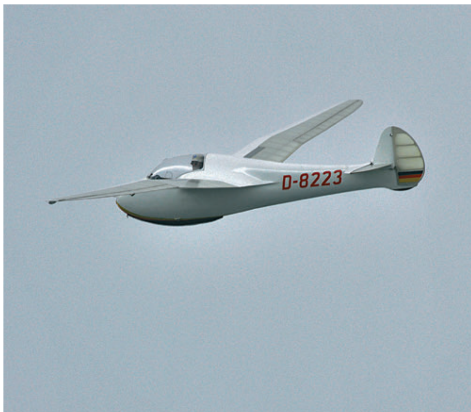
Lo Hütter Hü 28, con 12 metri d'apertura, ha un peso a vuoto di soli 88 kg
