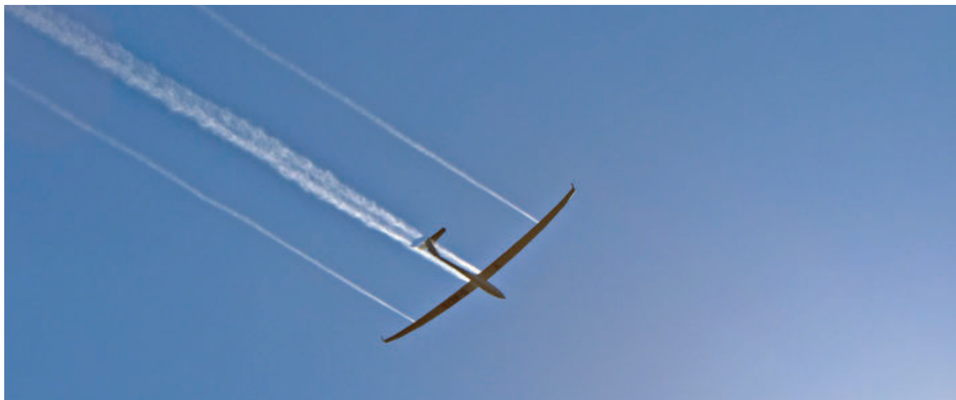
Scarico della zavorra d'acqua
