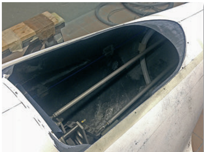
Il vano d'ispezione dietro all'abitacolo, modificato per accogliere in seguito le batterie del motore FES
