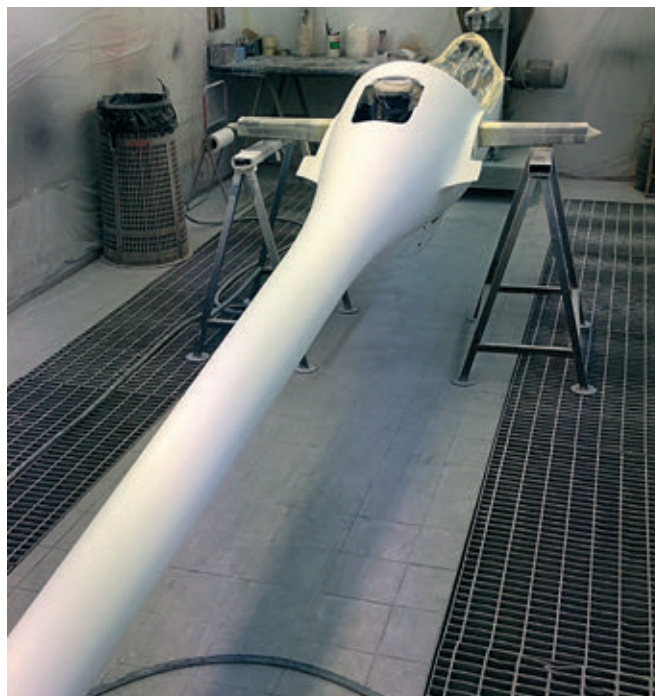
La fusoliera, dopo l'eliminazione del gelcoat, viene riverniciata in acrilico
