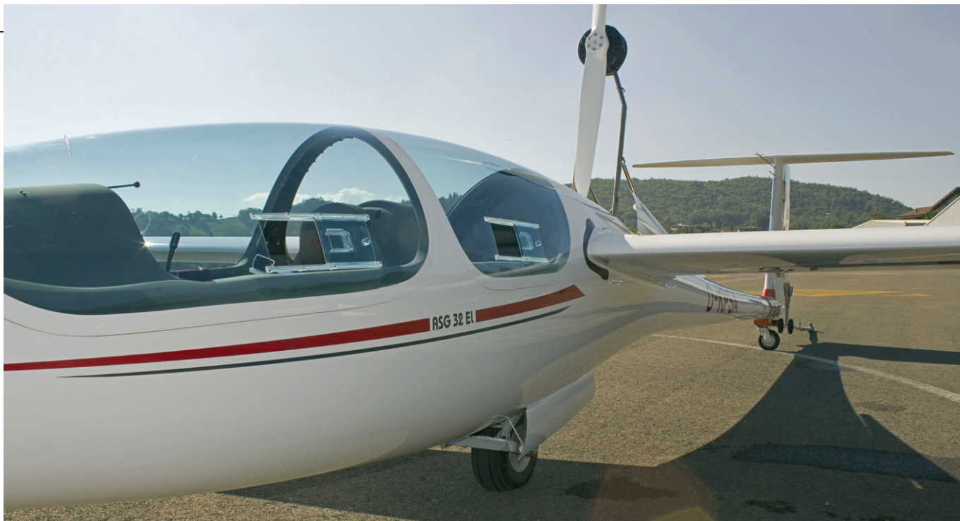
Fusoliera invariata, qualche affinamento negli abitacoli. Il ruotino di coda è fisso, mentre sull'Mi era sterzante e retrattile
