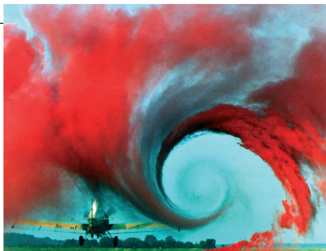
I vortici (uno per ogni semiala) generati da un aereo agricolo non dissimile dai nostri traini
