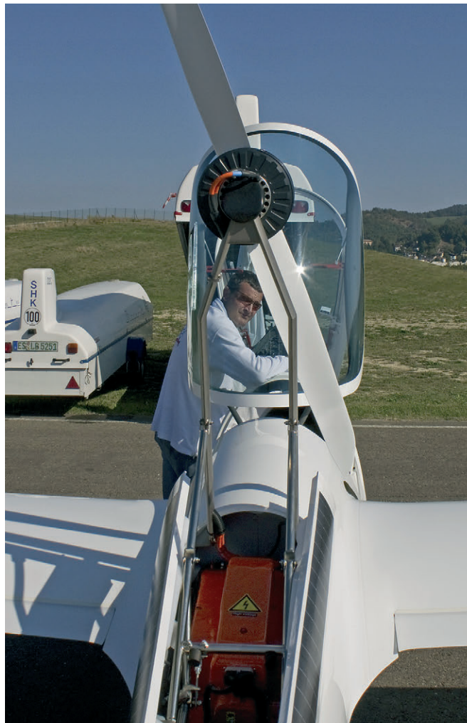
La vista posteriore evidenzia il contenitore delle batterie (in arancione)
