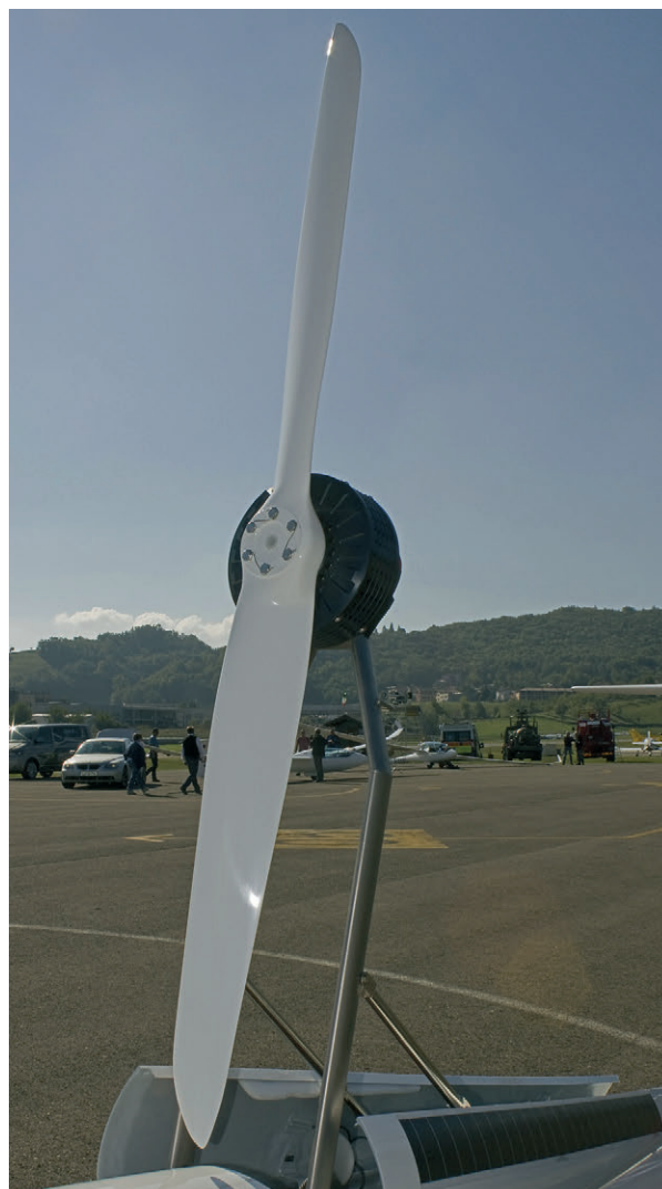
Il pilone che sostiene il motore e l'elica crea pochissima resistenza
