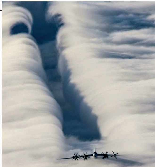
La discendenza dietro ad un aeromobile è come un solco, di larghezza costante
