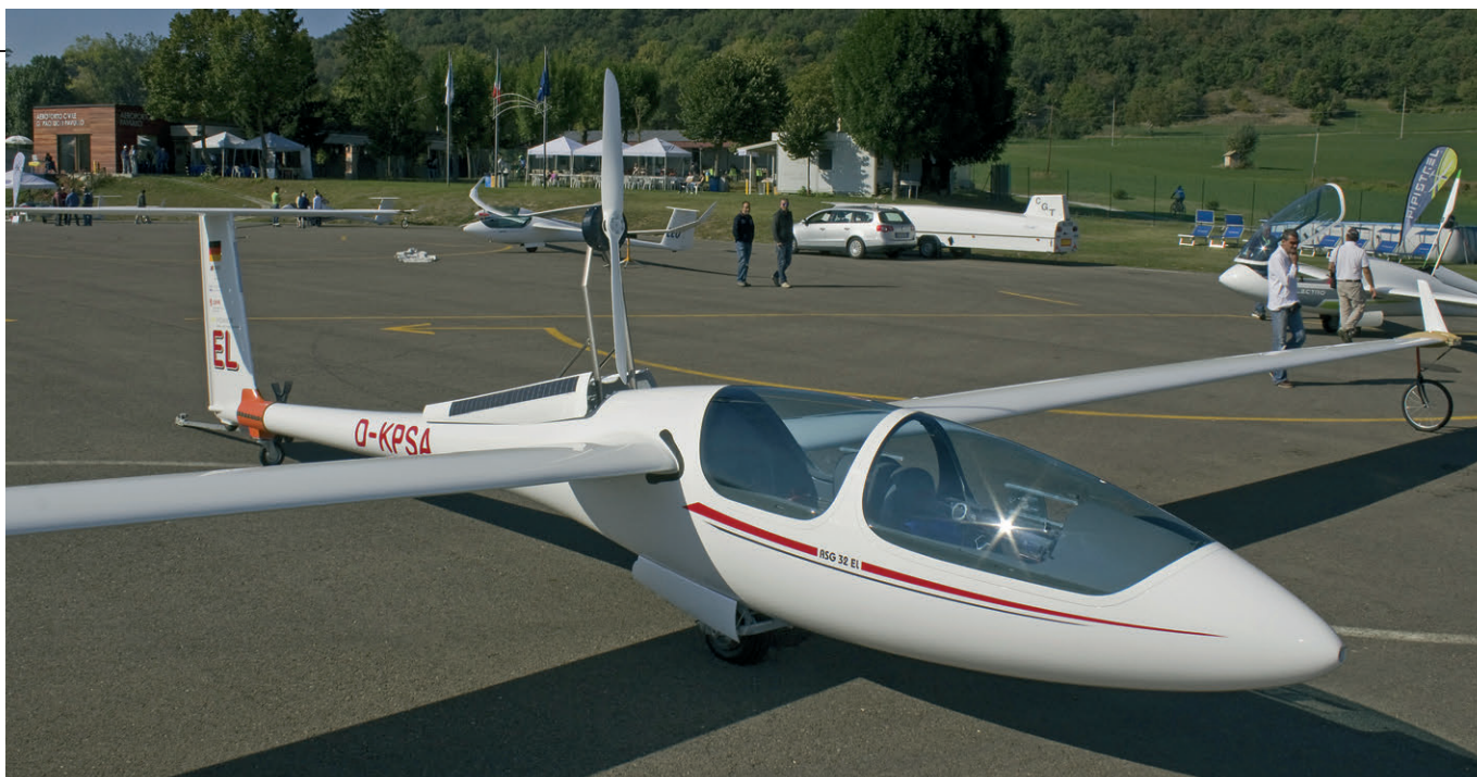
L'ASG 32 col nuovo motore elettrico, in prova a Pavullo durante il meeting annuale
