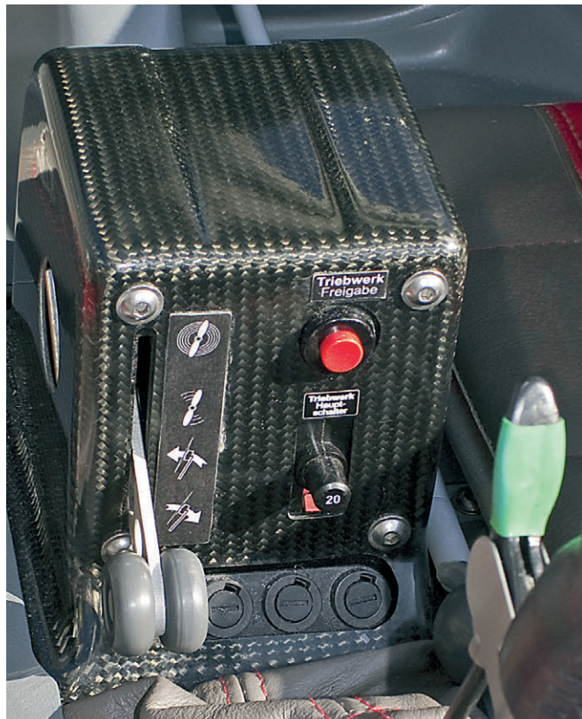
La scatola che ospita l'interruttore, la leva polifunzionale e il pulsante di avvio
