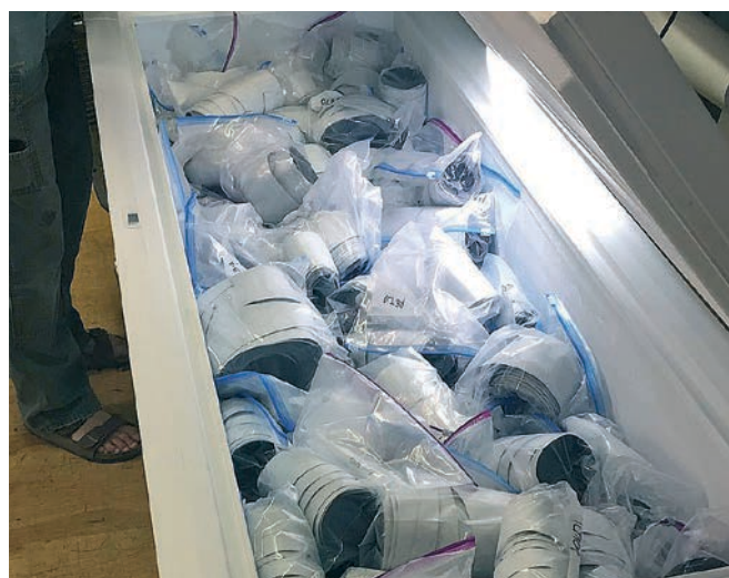
Dal tessuto pre-preg sono state tagliate centinaia di parti per i molteplici strati di laminazione. Poi l'imballaggio, etichettatura e conservazione in frigo.
