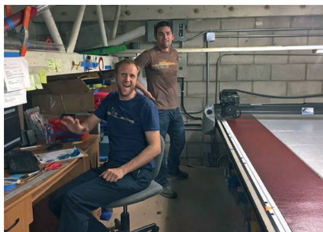
Dal tessuto pre-preg sono state tagliate centinaia di parti per i molteplici strati di laminazione. Poi l'imballaggio, etichettatura e conservazione in frigo.
