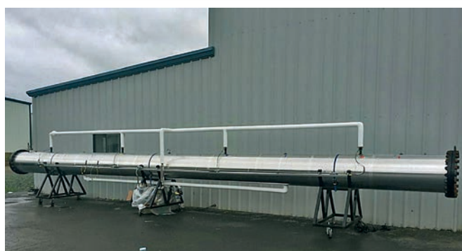
Due viste dell'autoclave (un forno) disegnato, costruito e infine collaudato con parti sacrificabili. È stato poi usato per "cuocere" le solette dei longheroni con eccellenti risultati
