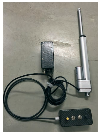
Un semplice attuatore lineare controlla già oggi i flap in ogni momento del volo (ASH30 modificato per Sergio Andrade)
