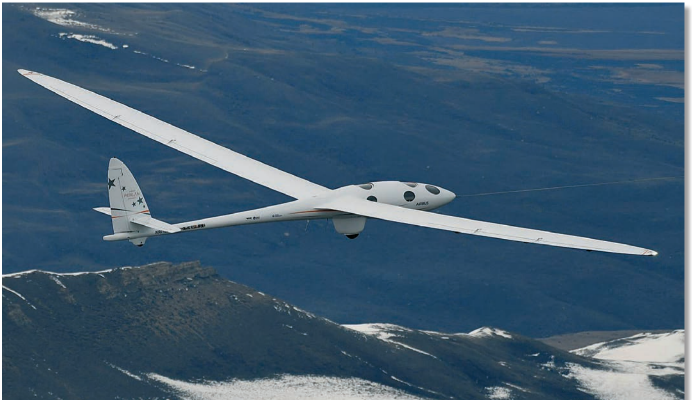
Il Perlan è un aliante pressurizzato. Una missione dura in media 4-5 ore
