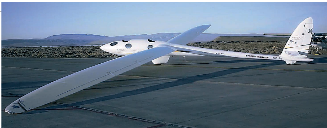
Il Perlan 2, costruito da Windward Composites in USA e legato allo sponsor attuale, la Airbus. La ruota principale non è retrattile per motivi di spazio (quasi tutto occupato dagli impianti a bordo) e di ammortizzazione
