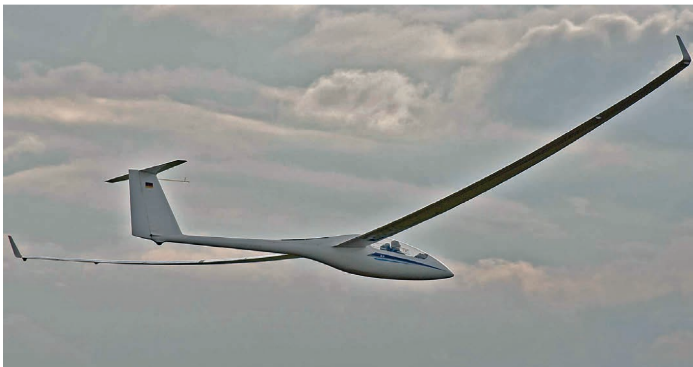
Un aliante EB28 Binder. Derivato dal più diffuso ASH25, con apertura alare maggiorata, modifiche al profilo e un abitacolo più lungo e ampio protetto da una capottina monopezzo
