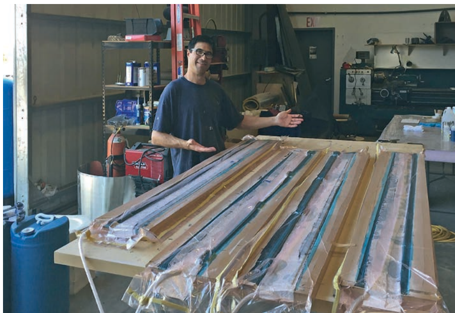
Di solito un Libera ha il flaperone diviso in tre parti per ogni semiala. Il Nixus ne avrà sei. Ci sono quindi 24 pezzi di laminato in lavorazione
