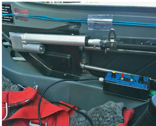
L'attuatore dei flap (sganciabile) ora installato per i test sull'ASH30
