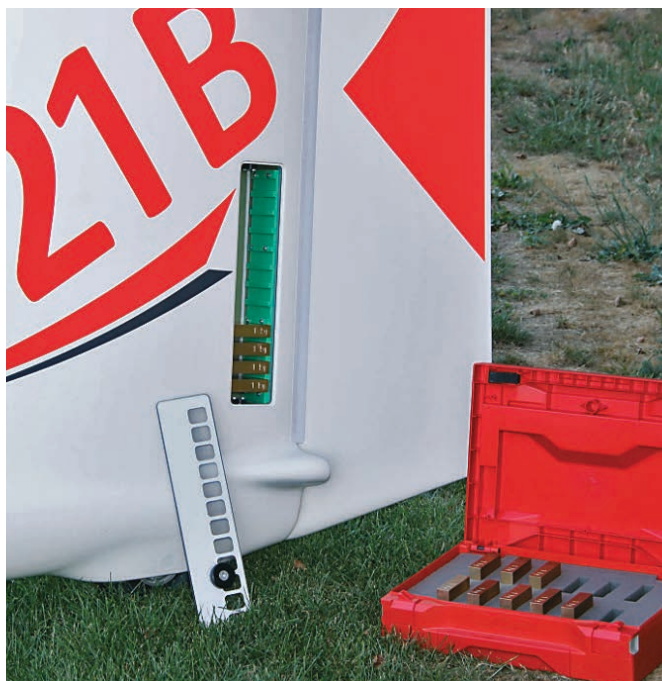
Ora anche il K 21 dispone di un alloggiamento per zavorre nella deriva
