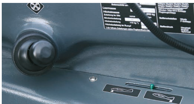
L'indicatore della posizione del trim e la bocchetta di ventilazione
