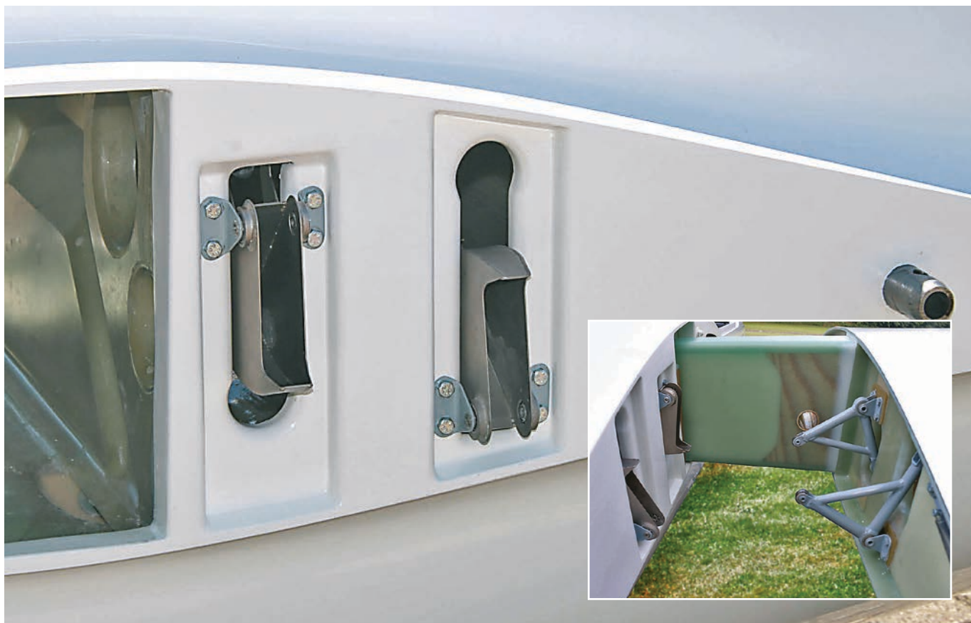
Due viste del sistema di connessione automatica dei comandi di volo. Un ammodernamento molto significativo
