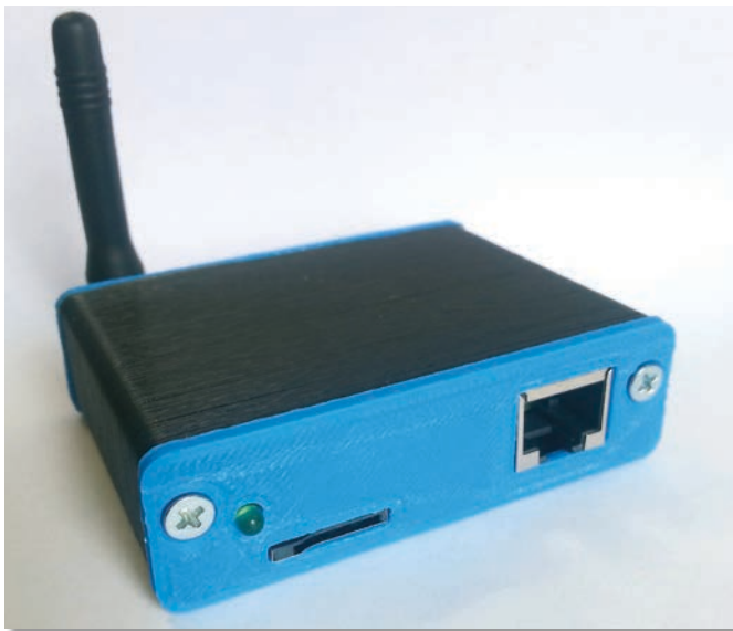
Unità di tracking OGN basata su progetto open source
