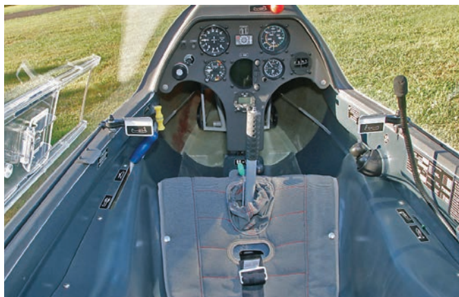
Barra avanzata, sedile più reclinato, e più spazio per piloti di alta statura. Il cruscotto interferisce meno con le ginocchia
