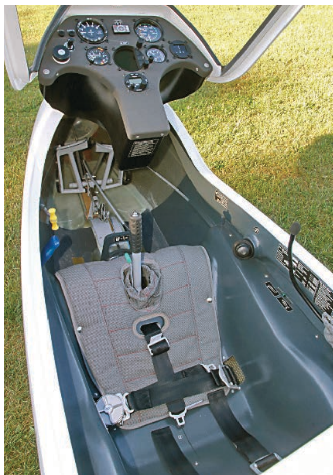
Barra avanzata, sedile più reclinato, e più spazio per piloti di alta statura. Il cruscotto interferisce meno con le ginocchia
