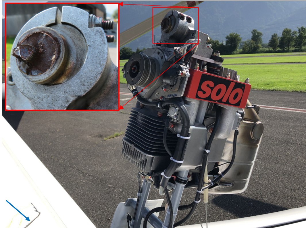
Abbildung 3: Hilfsmotor der HB-2467, der nach der Landung in Schänis zwecks Inspektion manuell ausgefahren wurde. Die Bruchstelle der exzentrischen, nicht rotierenden Propellerachse ist im rot umrahmten Ausschnitt erkennbar. Auf der rechten Tragfläche sind Schnitte in der Beplankung sichtbar, die der Propeller verursachte (blauer Pfeil).
