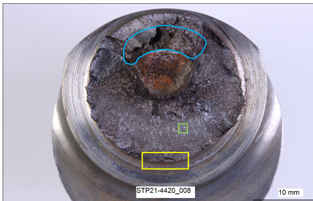
Abbildung 6: Bruchfläche mit der Rissausgangszone (gelbes Rechteck), Ausschnitt aus der Schwingbruchzone (grünes Rechteck) sowie Restbruchfläche (hellblaue Umrandung), vgl. Abbildung 7 bis Abbildung 10.
