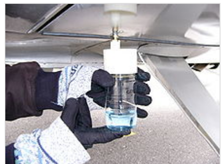
Campione di combustibile prelevato dalla valvola di scarico sotto un'ala, utilizzando un apposito contenitore per l'analisi dei campioni "GATS Jar fuel sampler". Il colore blu del liquido indica che si tratta di avgas 100LL.
