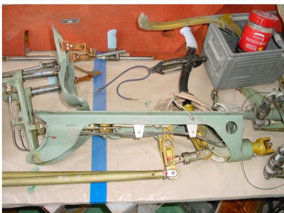
Steuerung unter dem Pilot nach Ausbau
