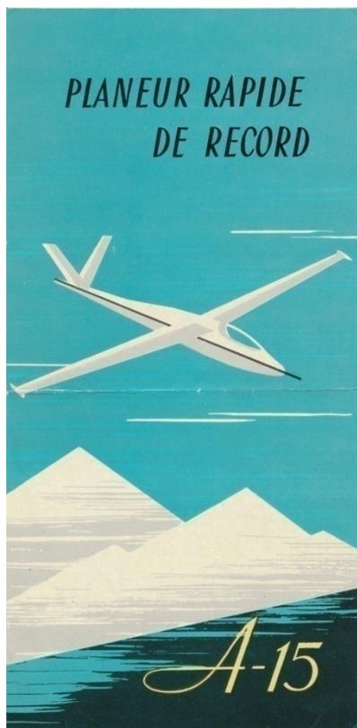
L'avion voilier A-15 est un planeur de vol à voile monoplace entièrement métallique à voilure à profil laminaire. Toute la surface du planeur est polie.
