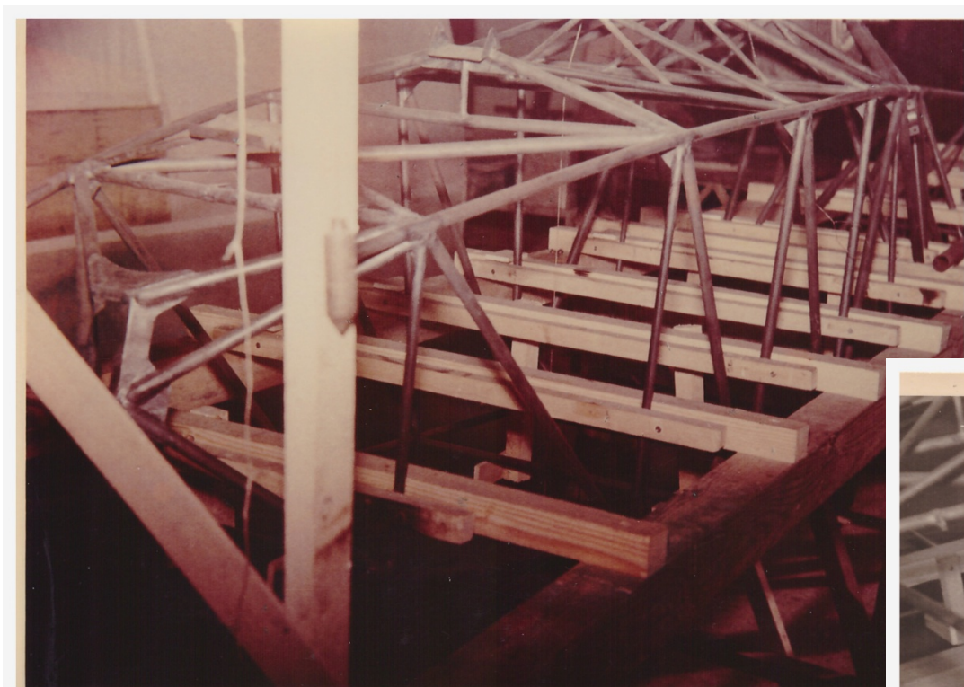
La fusoliera dell' Urendo in fase di allestimento sullo scalo di costruzione
