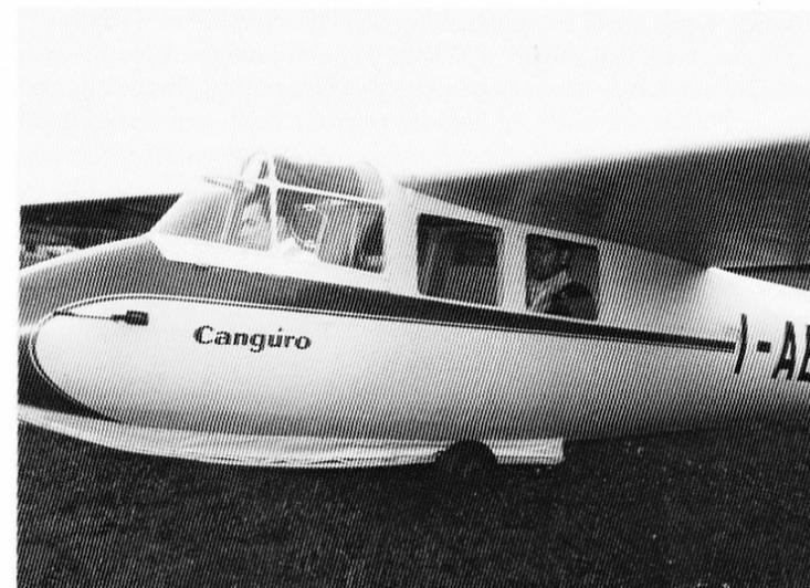
Il Canguro utilizzato a Vergiate per la scuola in doppio comando. L'istruttore si calava dall'alto nel pozzetto riservato al posto di pilotaggio posteriore.
