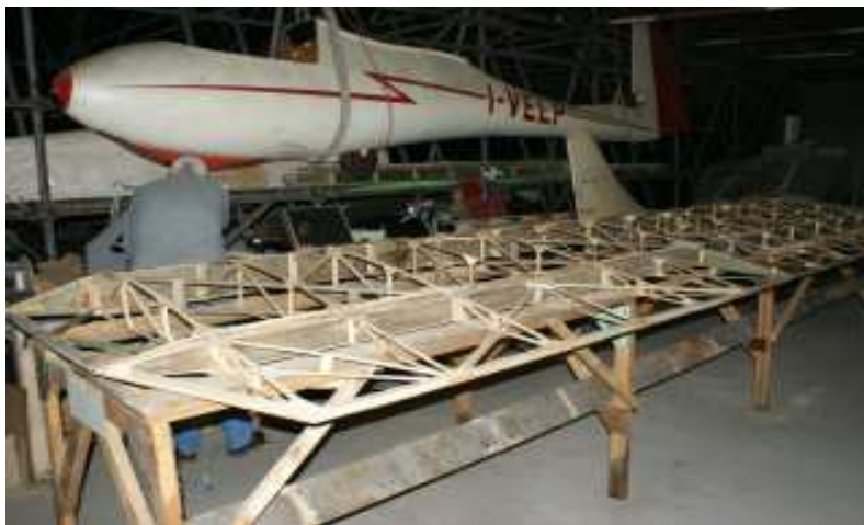
Un'altra immagine della struttura dell'ala. Alla base dello scalo è visibile il longherone dell'ala destra unico elemento che è stato possibile recuperare
