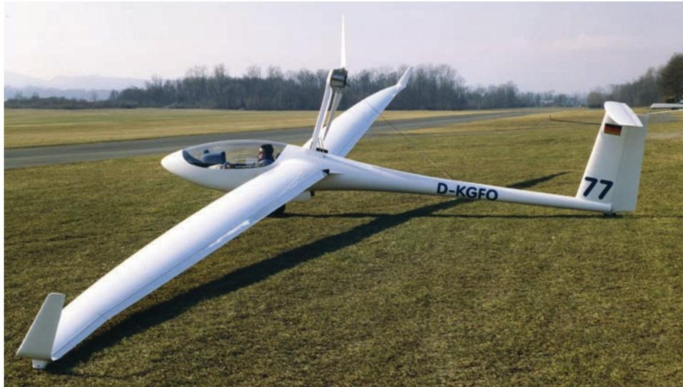
L' "Antares" a decollo autonomo con motore elettrico
