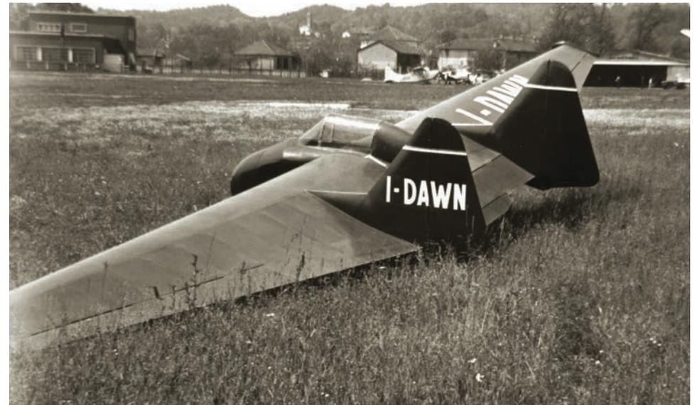
*Nei primi anni cinquanta vola in Francia l'aliante tuttala Fauvel AV 36. Attilio Pronzati e Franco Pavesi, esperti piloti di Vergiate, ne acquistano i disegni costruttivi e i lavori per la realizzazione iniziano nel laboratorio del club. Il collaudo in volo avviene nel giugno 1954 ad opera di Attilio Pronzati e questo aliante dall'insolito aspetto volerà per molti anni anche a Calcinate*
