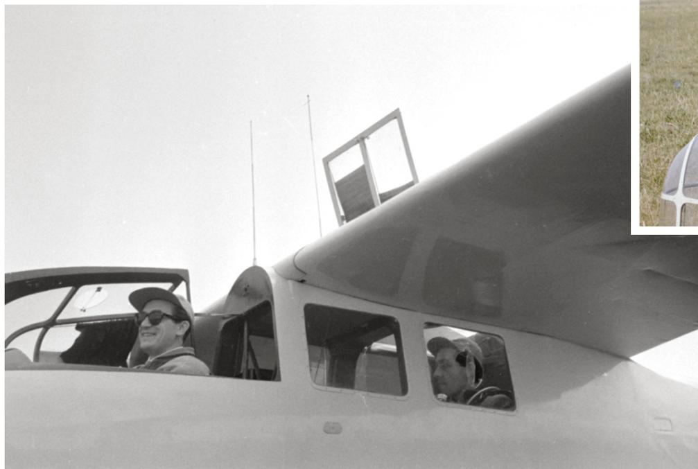
Nel prototipo I-CICI il tettuccio del posto anteriore doveva essere rimosso per l'accesso del pilota (vedi foto sopra). In seguito il tettuccio fu incernierato sul lato destro della fusoliera (vedi foto a sinistra). In entrambi i casi fu assicurata la possibilità di sgancio in volo in condizioni di emergenza. Anche la botola del posto di pilotaggio posteriore era facilmente sganciabile mediante un comando che estraeva la cerniera dai suoi supporti.
