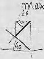
Poiché i semipiani hanno  $40^\circ$  di angolo con l'orizzontale, posto che 106 kg sia la componente ~~di~~ vert di ciascuno, si ha un carico normale al semipiano di 140 kg, equivalente a 125 kg/mq: mentre nell'Umbel (v. calc stat max 59) è stato previsto 150 kg/mq.
