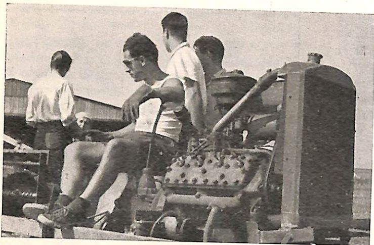
Il verricello Ford 8 V da c.c. 4.250 dell'A.V.M., uno dei più potenti. Con esso sono state raggiunte quote di 500 metri.
