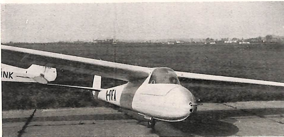
L'aliante dopo il primo volo attende di essere messo a riposare. Si notino il carrello completamente eclissabile ed il lungo tubo di Pitot che durante le manovre a terra può essere ritirato in fusoliera (Foto Zulli).
