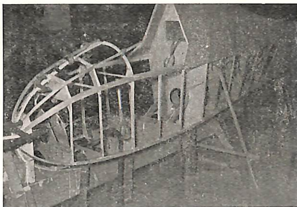
La fusoliera di un ASIAGO II in costruzione nel laboratorio del gruppo.
