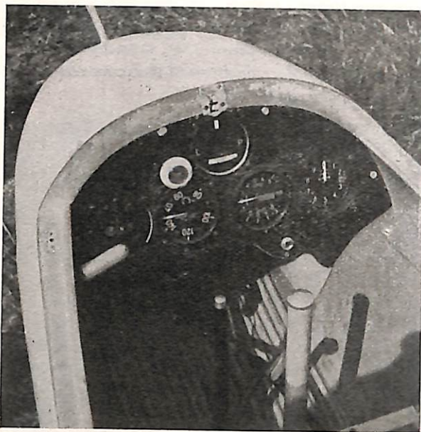
Il posto di pilotaggio di questo nuovo veleggiatore. A sinistra il comando dei diruttori, al centro, davanti alla cloche, la leva di azionamento del carrello ed il dispositivo di allungamento della pedaliera. Gli strumenti, di grande precisione e sensibilità, sono ridotti al minimo indispensabile (Foto Zulli).
