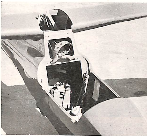
L'interno della cabina di uno Slingby Sky 34 mostra la razionalità delle installazioni. Si notano il barografo e l'impianto radio. (Foto Zanetti).
