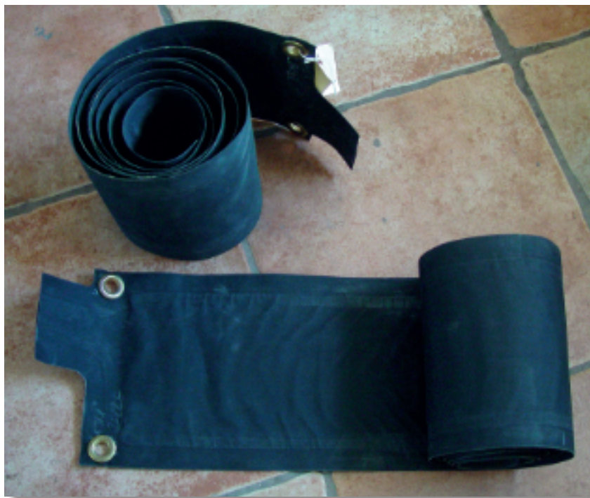
Un set di serbatoi alari in tessuto impermeabile, nuovi, per il Libelle
