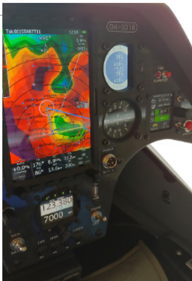
A destra, MCU motore, pulsante avviamento, spia antincendio
