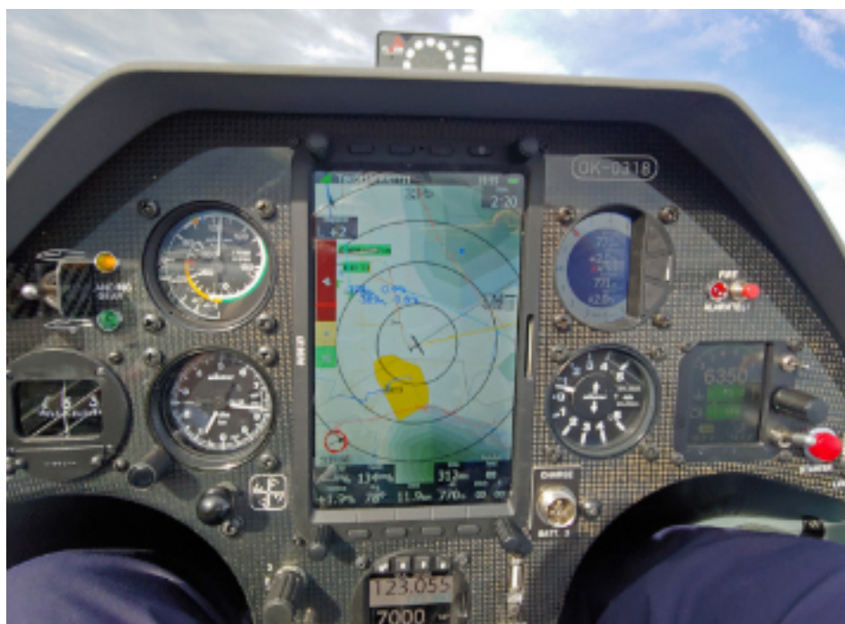
Il cruscotto ha il top piatto, per più visibilità anteriore rispetto al prototipo
