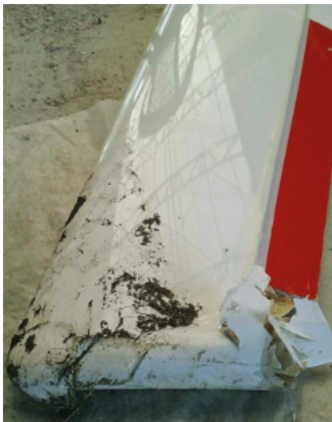
L'estremità sinistra con segni di contatto al suolo
