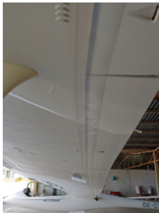
Turbolatori soffianti nei flap-alettoni, prese NACA
