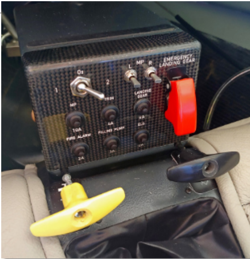
Il quadro elettrico coi comandi 02, nettamoscerini e apertura carrello in emergenza
