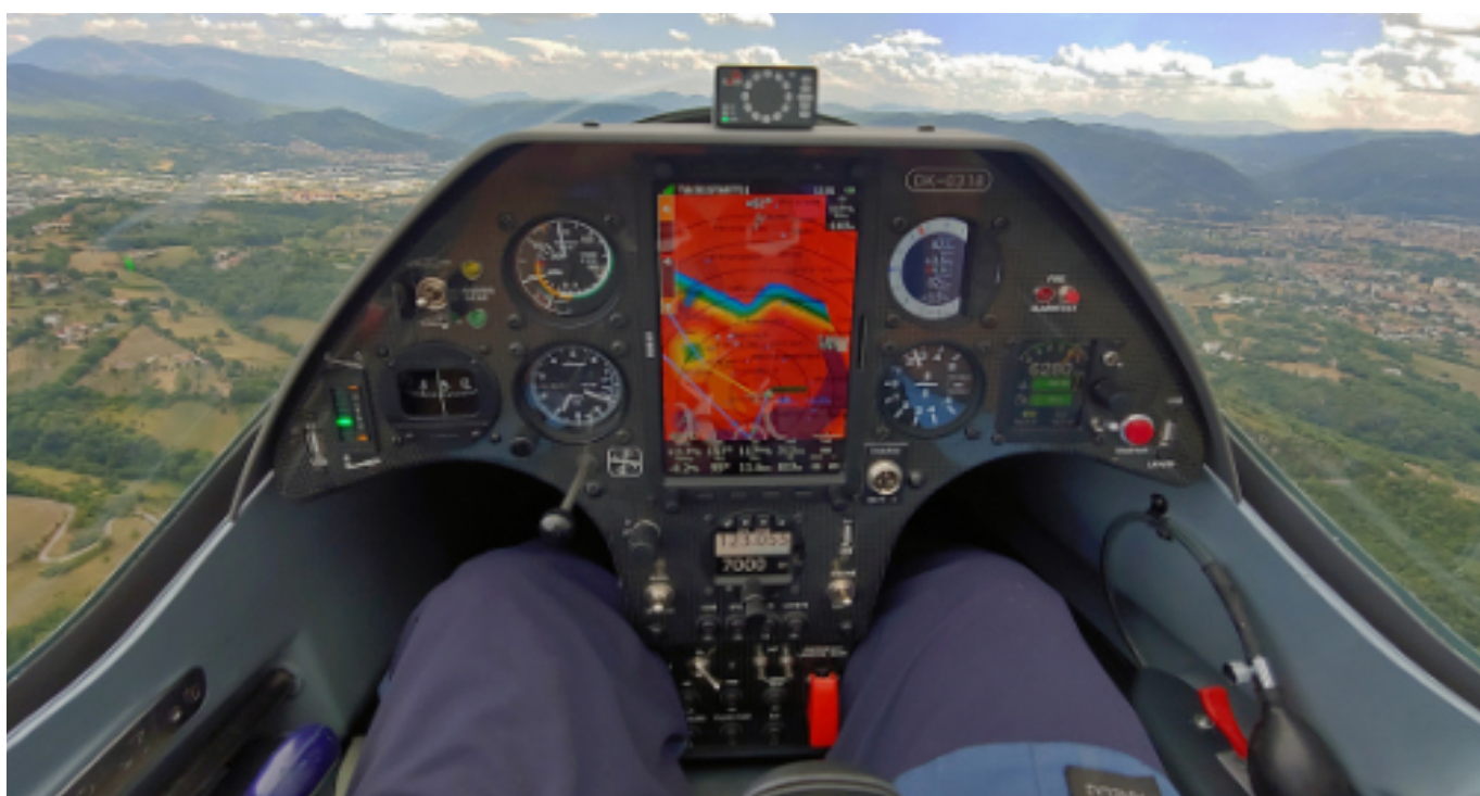
In salita a motore su Rieti. A sinistra la spia di posizione del trim elettrico. A destra la pompetta di avviamento. Ampio spazio a disposizione
