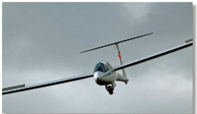
In atterraggio, la versione con carrello "alto"
