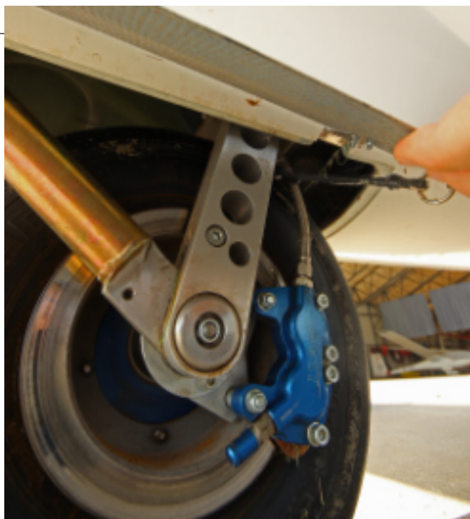
Ruota principale, struttura e freno a disco Tost
