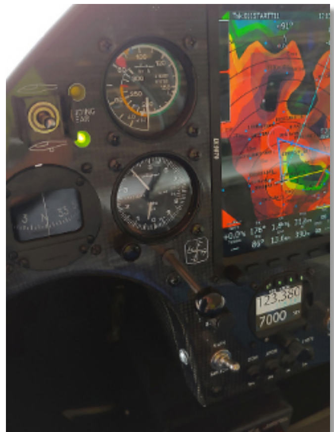
Spia verde per il carrello estratto. Tempo di azionamento 5 s
