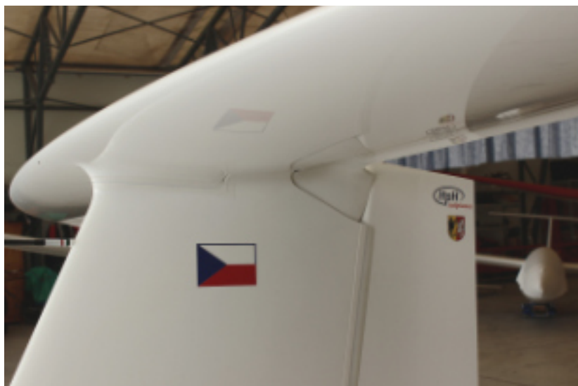
Il piano di coda ellittico e la cura nei raccordi aerodinamici
