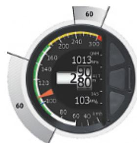
La scala delle velocità può essere lineare o logaritmica: quest'ultima permette di espandere l'arco di cerchio dedicato alle velocità di termica, comprimendo quelle di planata molto veloce che vengono usate ben più raramente. Pure gli archi colorati della VA e VNE, e le altre velocità di riferimento, sono completamente modificabili dall'utente, e trasferibili via SDcard.
