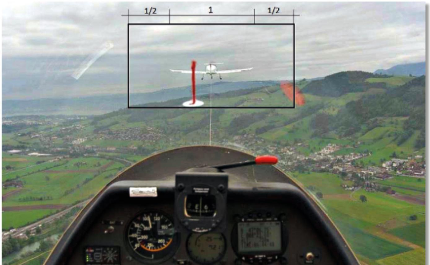
**Posizione corretta con cavo allineato alla fusoliera del traino, e confini di posizione: 1 indica l'apertura alare del traino; la larghezza totale della finestra consentita è pari a due aperture alari, riferimento apparente  $1+(2 \times 1/2)$ . Fonte: BFU, Svizzera**
