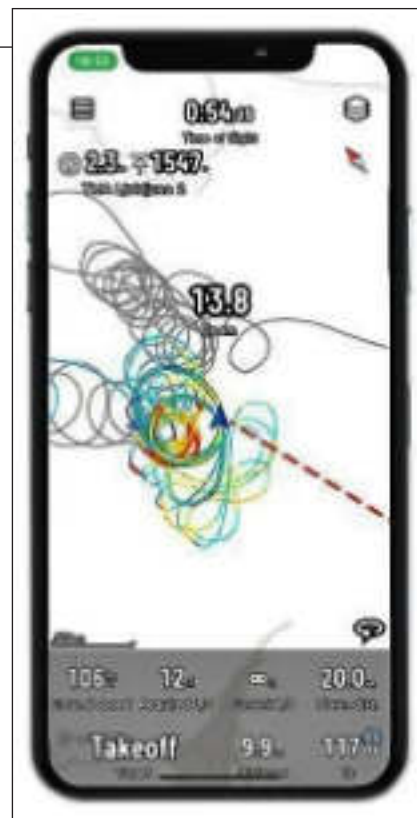
L'assistente di termica facilita il centraggio. È affidabile soltanto se il telefono dispone di un GPS interno molto preciso
