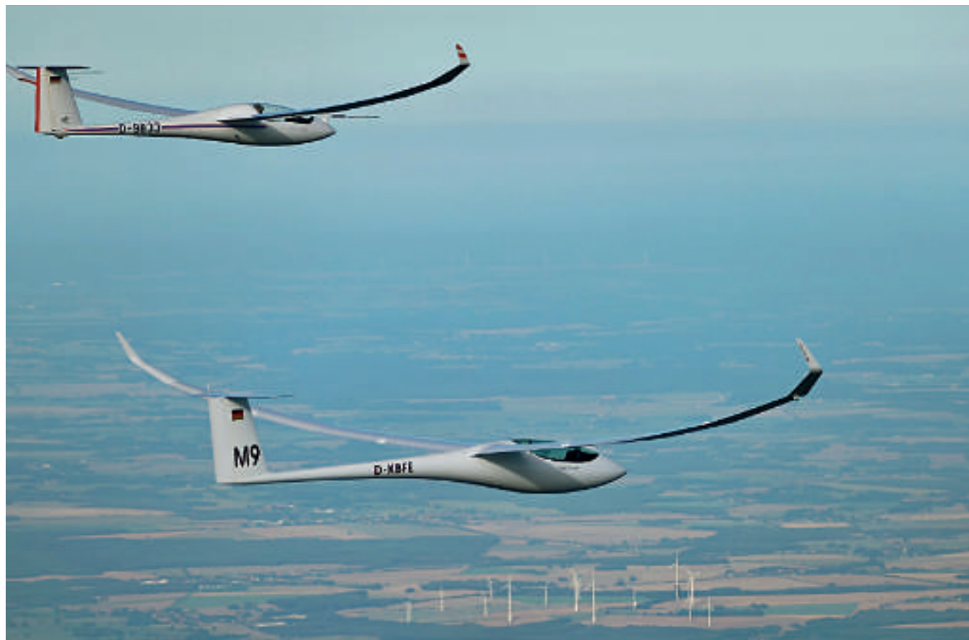
Un volo di misurazione del JS3 durante la riunione estiva Idaflieg. L'efficienza misurata è pari a 57 (con 18 m d'apertura)
