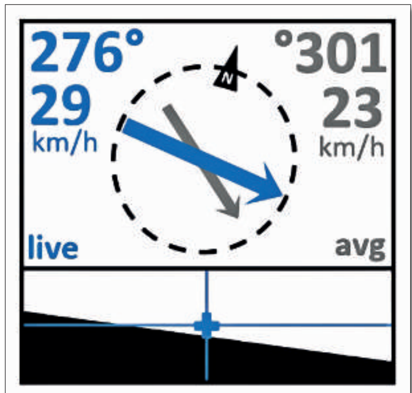
La semplice grafica del display di Anemoi, piccolo strumento che calcola e indica il vento grazie ad avanzati algoritmi e alla piattaforma inerziale
