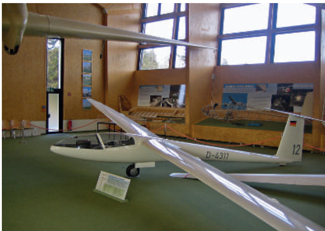
Il prototipo del D-36 Circe nella versione modificata (purtroppo) dal proprietario: molto diversa è la linea della capottina
