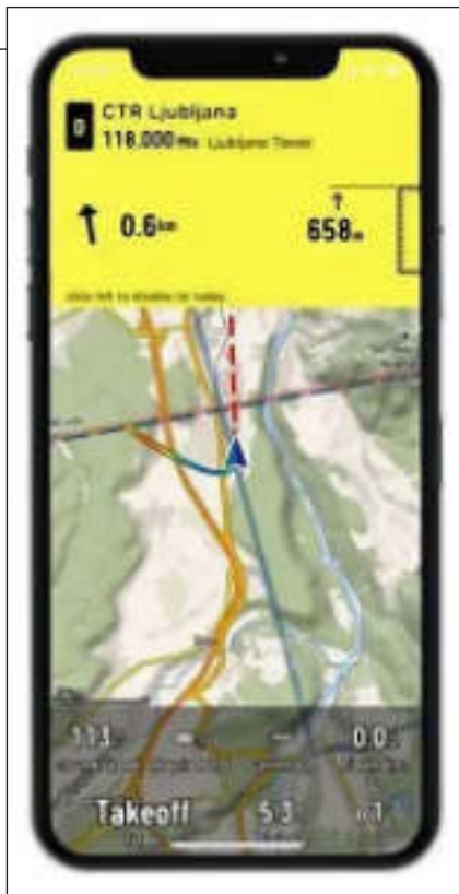
La schermata di allarme prossimità di uno spazio aereo, che appare in primo piano quando necessario
