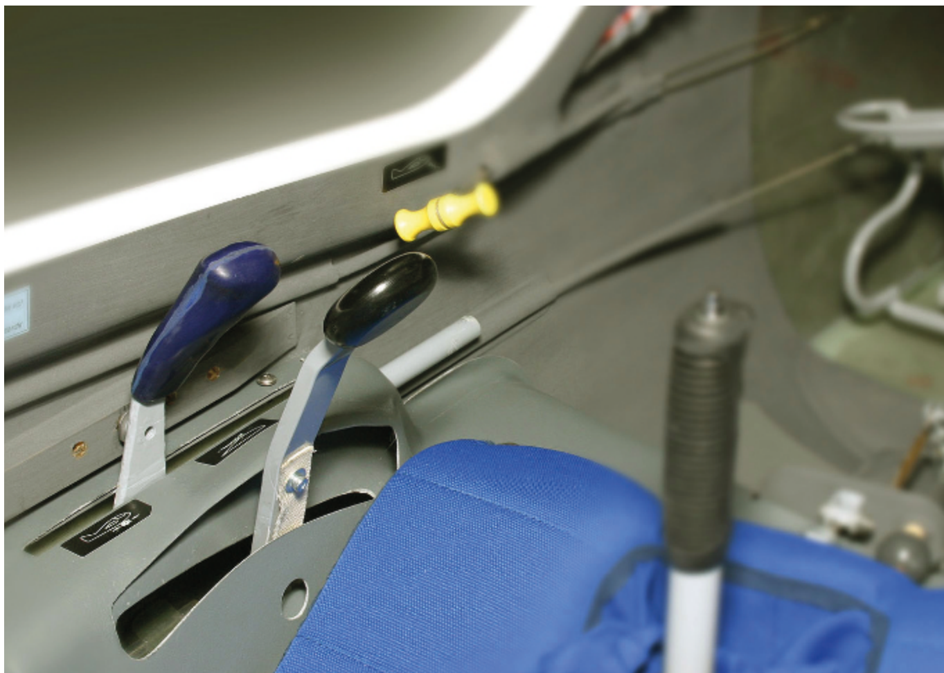
Impianto anteriore di comandi manuali del timone, con la leva nera che lo spinge a destra e sinistra. Le tacche sul comando dei diruttori permettono di bloccarli nella posizione desiderata, liberando la mano sinistra per l'uso del timone
