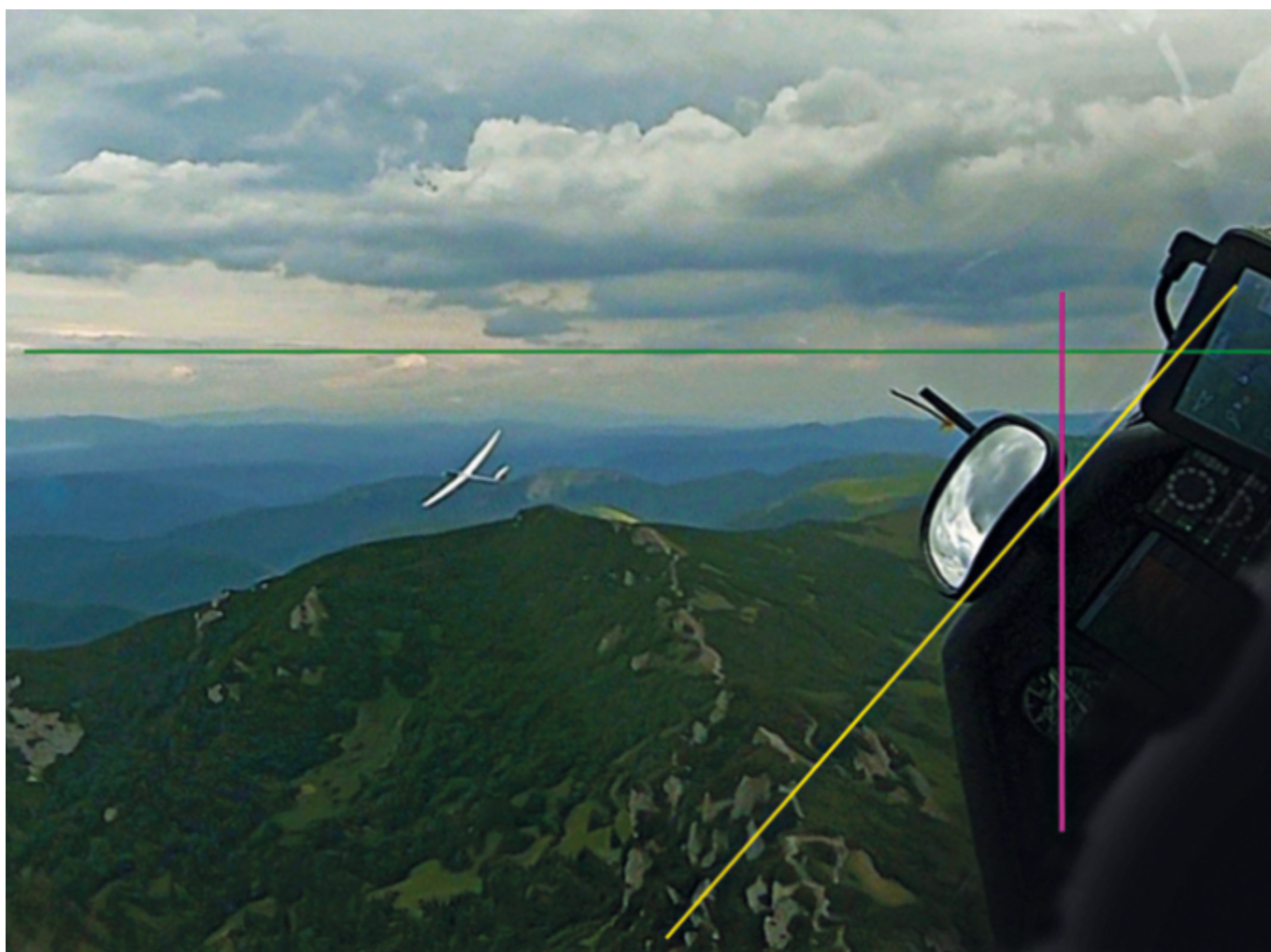
45^\circ è l’inclinazione ideale. La linea gialla è parallela al piano del cruscotto, quella viola è diagonale a uno strumento circolare
