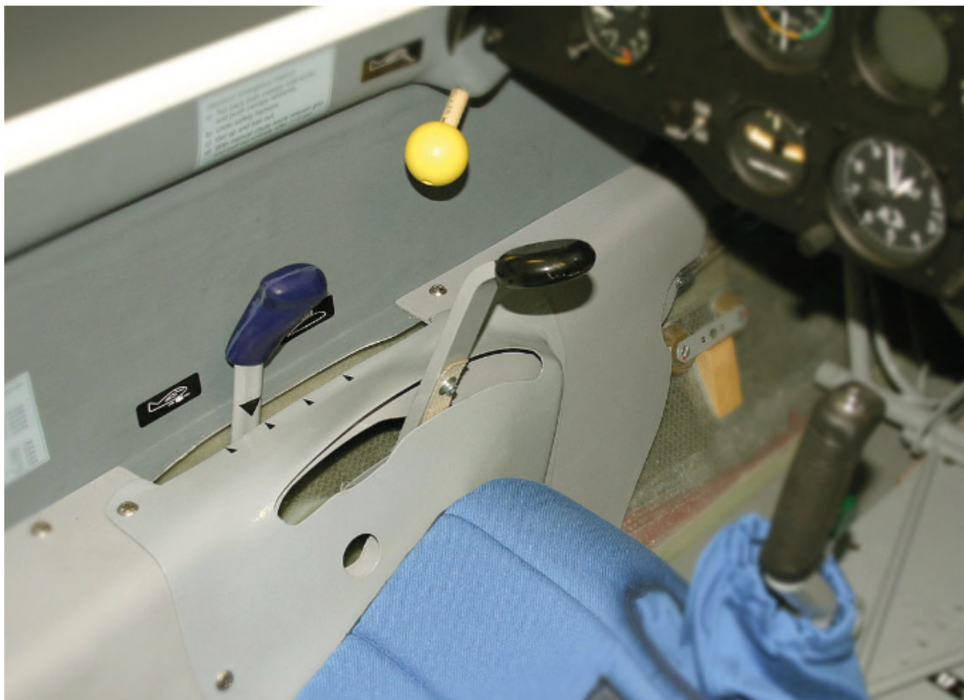
Stesse modifiche al posto posteriore, ma le tacche dei diruttori sono nascoste nella carenatura
