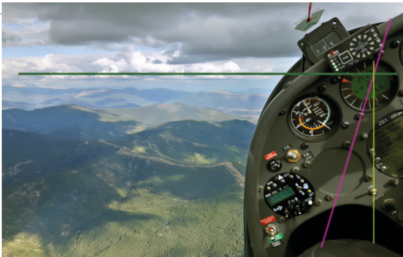
Inclinazione di circa 30^\circ , il “minimo sindacale”. L’immaginaria linea viola unisce due viti di uno strumento circolare; quando sarà perpendicolare all’orizzonte geofisico (in verde), saremo a 45^\circ
