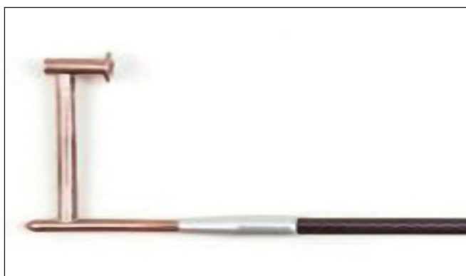
Una sonda basata su un piccolo Venturi, anziché i semplici forellini
