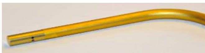
I due forellini ben disposti nella sonda Ilec
