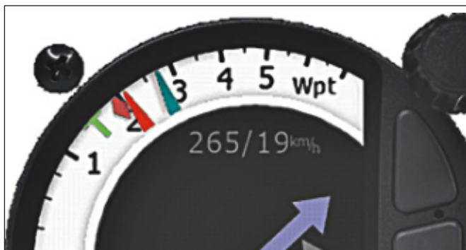
LXNav S100: in rosso la salita misurata da Total Energy, in blu quella indicata da Hawk
