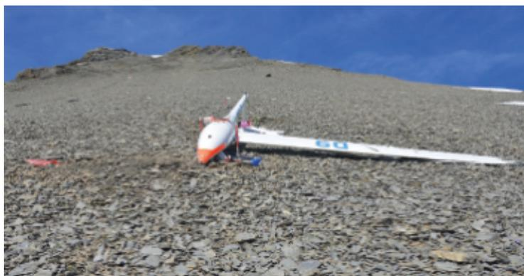
Figura 5: Posizione finale della fusoliera con l'ala destra. Foto: Polizia cantonale di Berna
