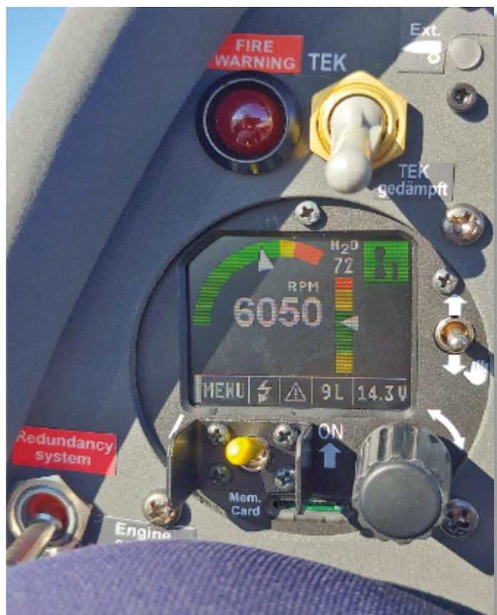
Motore in funzione, temperatura 72°, batteria e carburante OK
