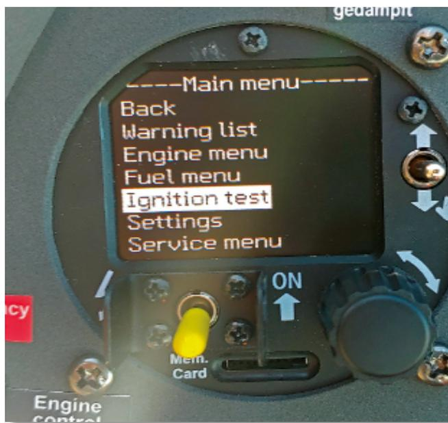
L'ECU esegue il check magneti automatico
