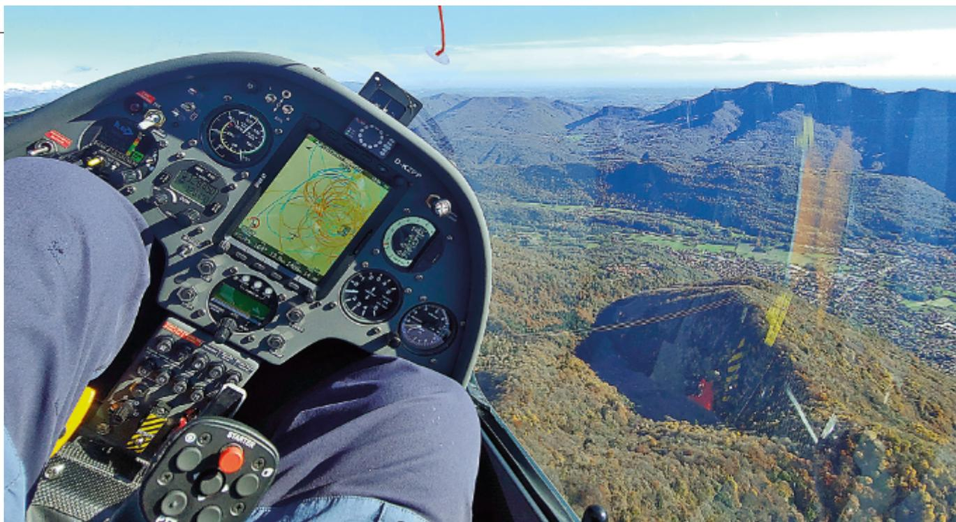
Le mie ginocchia interferiscono con l'interruttore a sinistra (modalità Redundancy della mappatura elettronica del motore a iniezione)
