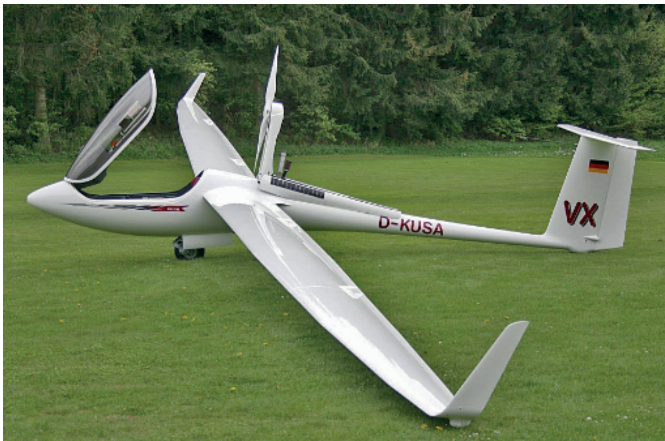
L'ASH 31Mi da 21 metri d'apertura, un bel classe Libera monoposto. Il suo fattore DMSt è 125, come per l'EB 28 Edition
