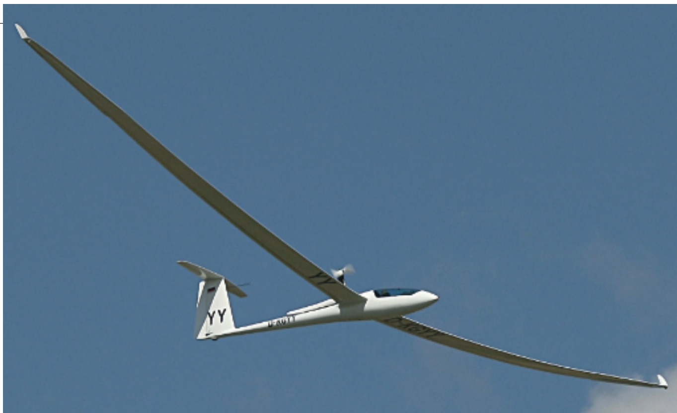
Il Nimeta X è stato realizzato da Bruno Gantenbrink unendo le ali dell'Eta alla fusoliera monoposto Nimbus. Il suo è il secondo handicap della gerarchia DMSt, con 128 punti
